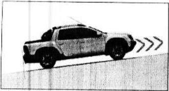
assistente de partida em rampa Mantém a pressão do freio por dois segundos, evitando a reversão quando você se afasta em um deslize controlado.
